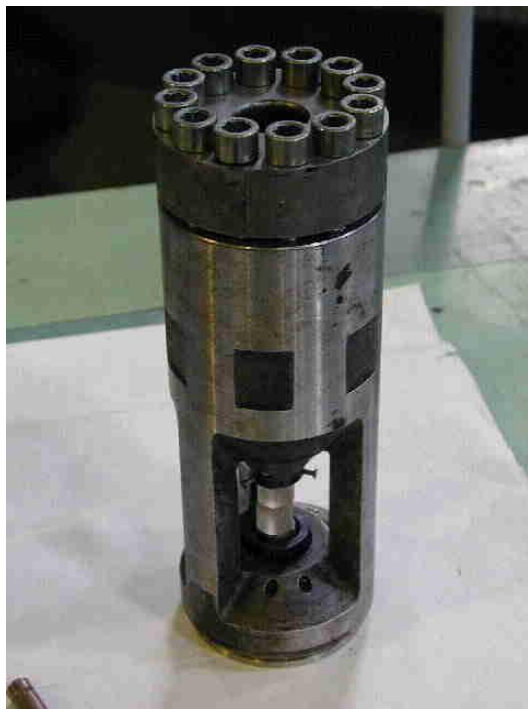
Ячейка высокого давления ( \varnothing 48 mm x 164 mm) с сапфировыми наковальнями, P до 7 ГПа
