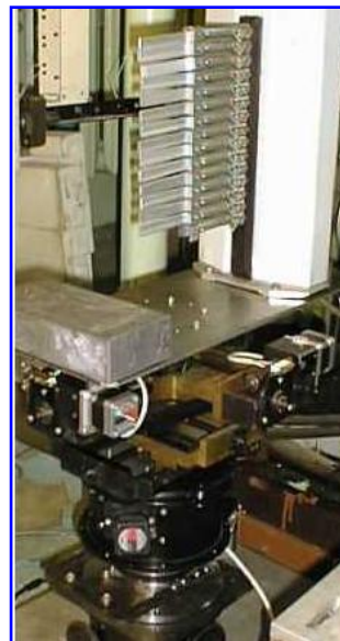
Фокусирующий монохроматор с механикой. 12 Ge-пластин, 12x60x8 мм
