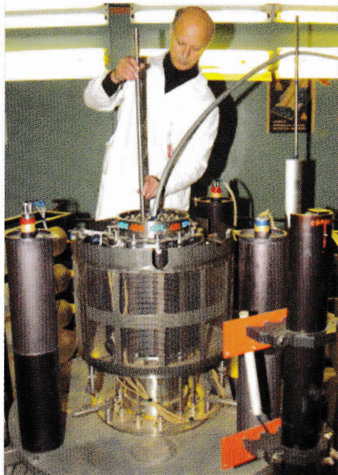
Критичесборка Нарцисс-М2. Загрузка твэлов в каналы имитаторов ЭГК перед началом эксперимента
