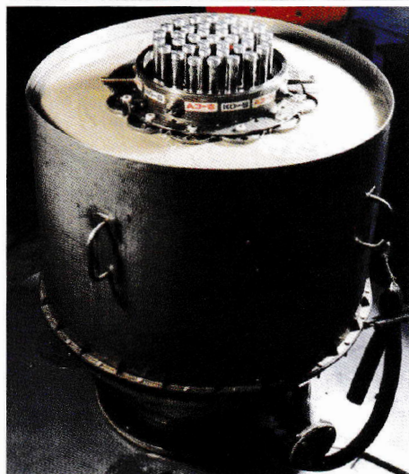
Критическая сборка Нарцисс-М2, помещенная в мокрый песок
