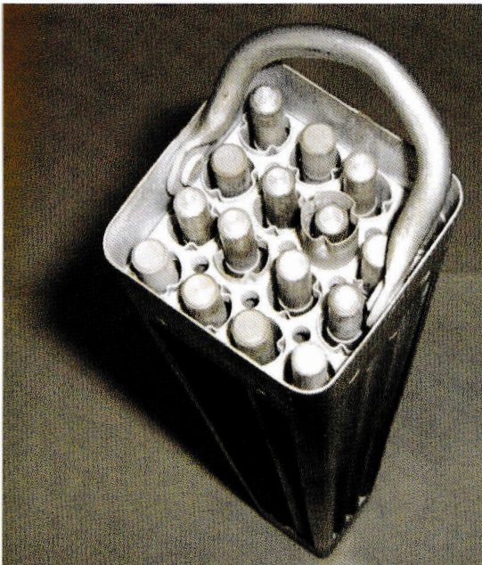
16-твэльная ТВС реактора ОР
