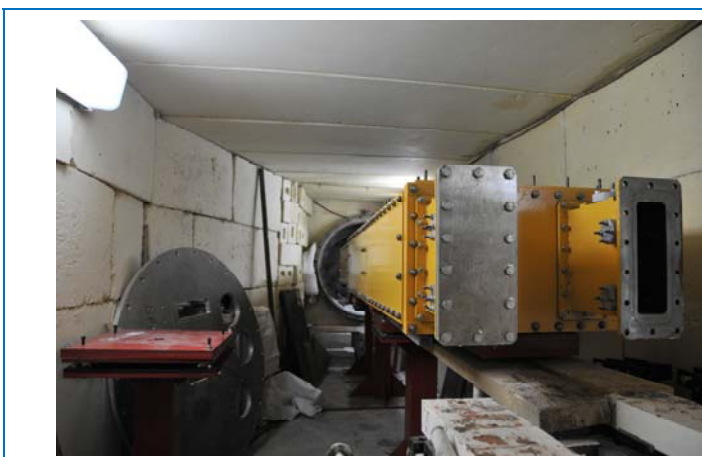
Рис. 12. Головная часть зеркального вакуумного нейтронновода, установленная на 6-м канале реактора ИБР-2 в рамках реализации про-екта по созданию нового дифрактометра для исследования микрообразцов ДН-6.
