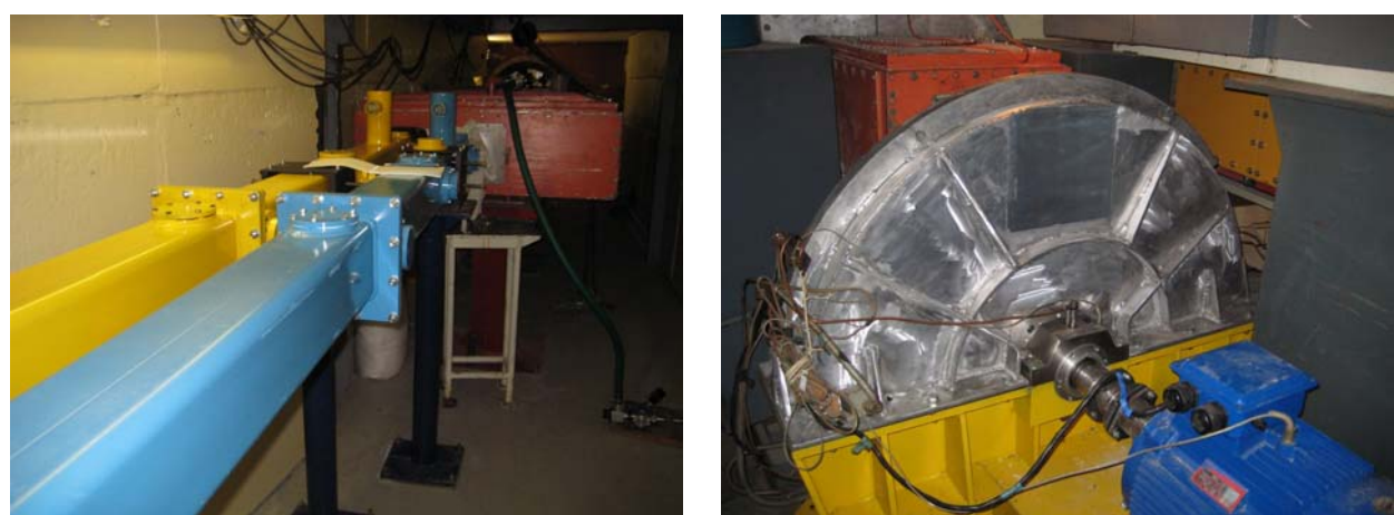
Рис. 14. Сплиттер, разделяющий исходный нейтронный пучок на три независимых пучка для спектрометров ЭПСИЛОН, СКАТ и НЕРА (слева) и новый фоновый прерыватель (справа) на 7 канале реактора ИБР-2.
