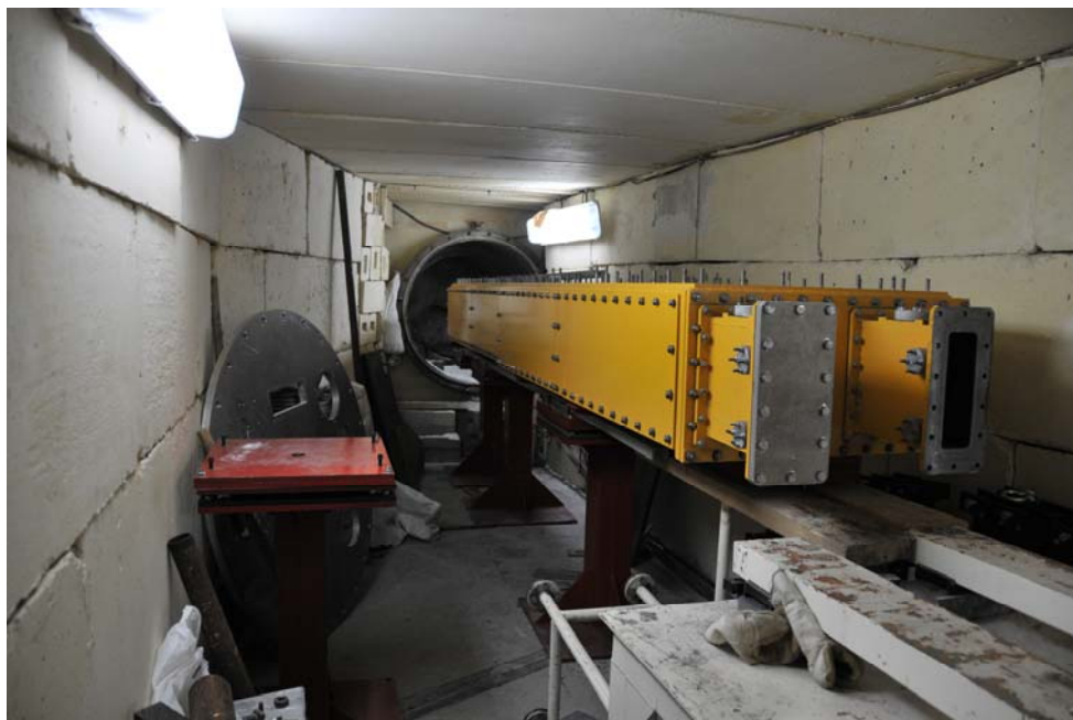
Рис. 10. Головная часть зеркального вакуумного нейтроновода, установленная на 6-м канале реактора ИБР-2 в рамках реализации проекта по созданию нового дифрактометра для исследования микрообразцов ДН-6.
