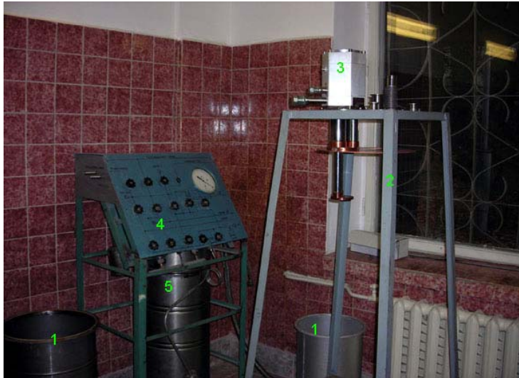
Рис. 8. Тестовый криостат криостенда (1 – криостат, 2 – стойка криостата, 3 – холодная головка, 4 – пульт управления системой циркуляции газа. 5 – бак хранения гелия-3).
