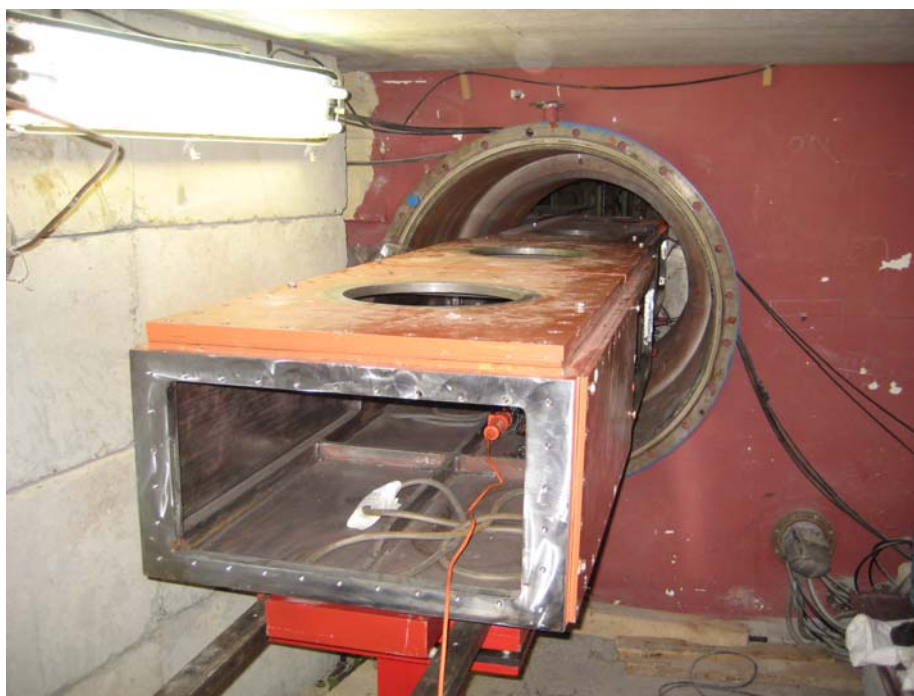
Рис. 13. Головная часть сплиттера 7-ого канала реактора ИБР-2М для нейтронотодной системы дифрактометров ЭПСИЛОН (7А-1), СКАТ (7А-2) и НЕРА (7В). Установка сплиттера производится в рамках проекта ВМВФ по модернизации нейтронотодной системы дифрактометров ЭПСИЛОН и СКАТ на канале 7А реактора ИБР-2М.
