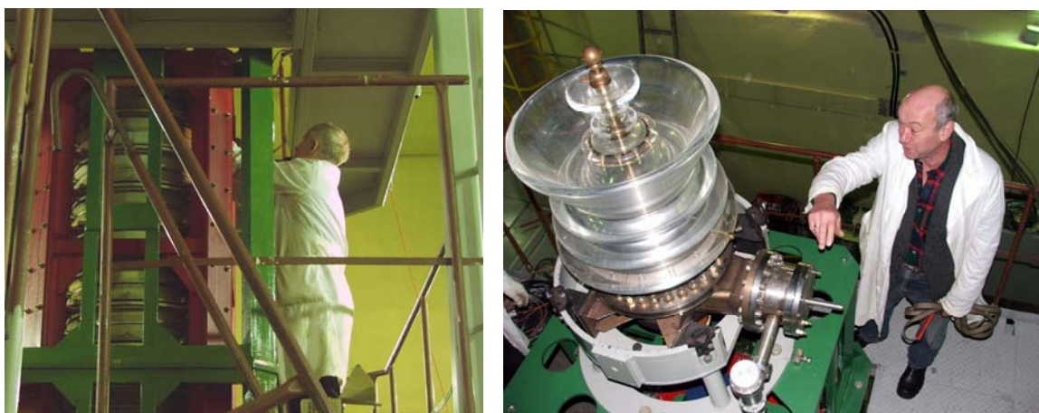
Рис. 2. Монтаж фокусирующего соленоида (слева) и электронной пушки (справа).
