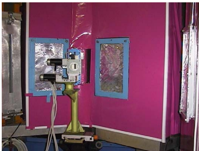
Рис.8. Регулируемая диафрагма с юстировочным устройством.
