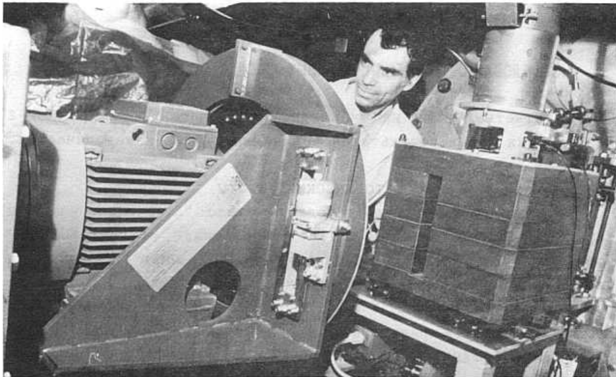
Фурье-прерыватель нейтронного дифрактометра высокого разрешения ФДВР на пучке № 5 реактора ИБР-2
