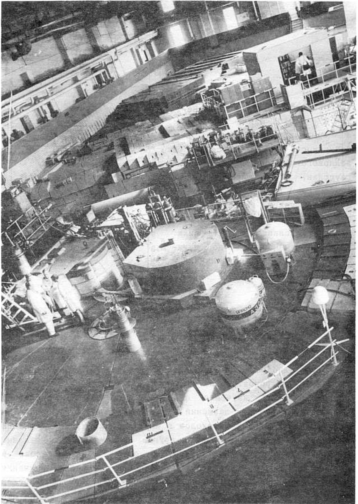
Спектрометр неупругого рассеяния нейтронов в прямой геометрии ДИН-2ПИ на пучке № 2 реактора ИБР-2
