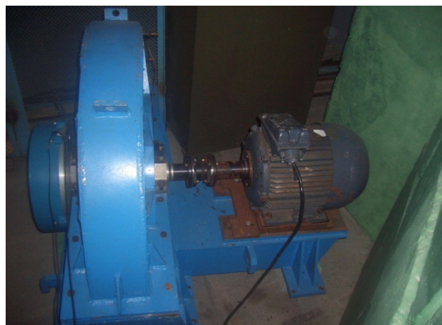
Рис.11. Дисковый фоновый прерыватель 7 канала ИБР-2М.
