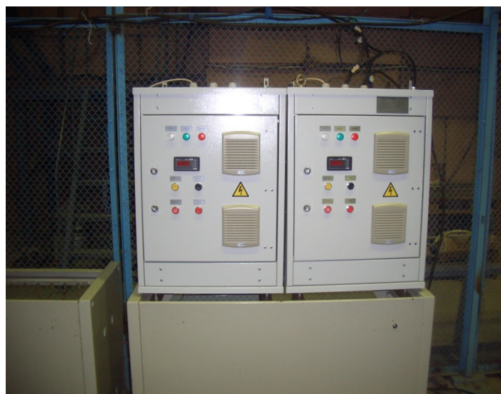
Рис.10. Электропривод фирмы Toshiba 22 кВт для фонового прерывателя (слева) и два электропривода 2,2 кВт для λ-прерывателей (справа).
